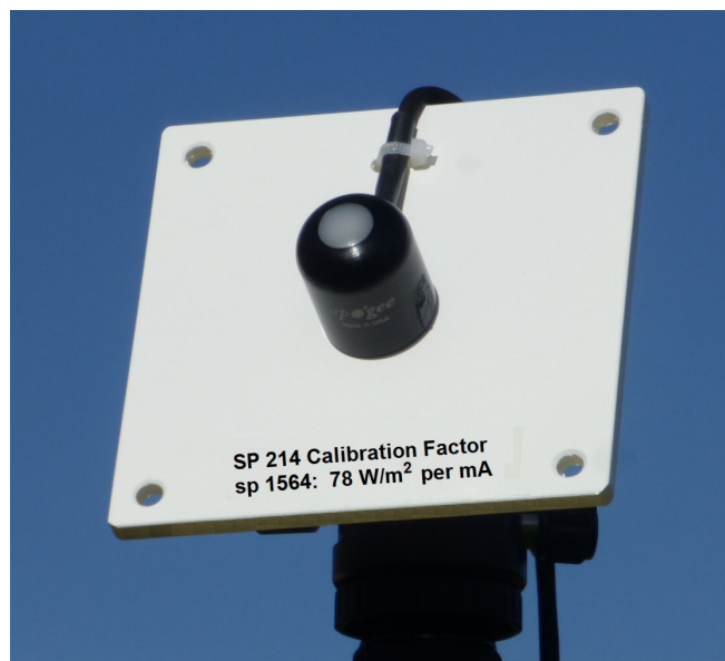
Figur 2: Apogee SP-214 (4-20 mA) pyranometer leveres med 5 m kabel. 4-20 mA forstærkeren er monteret i kablet.
